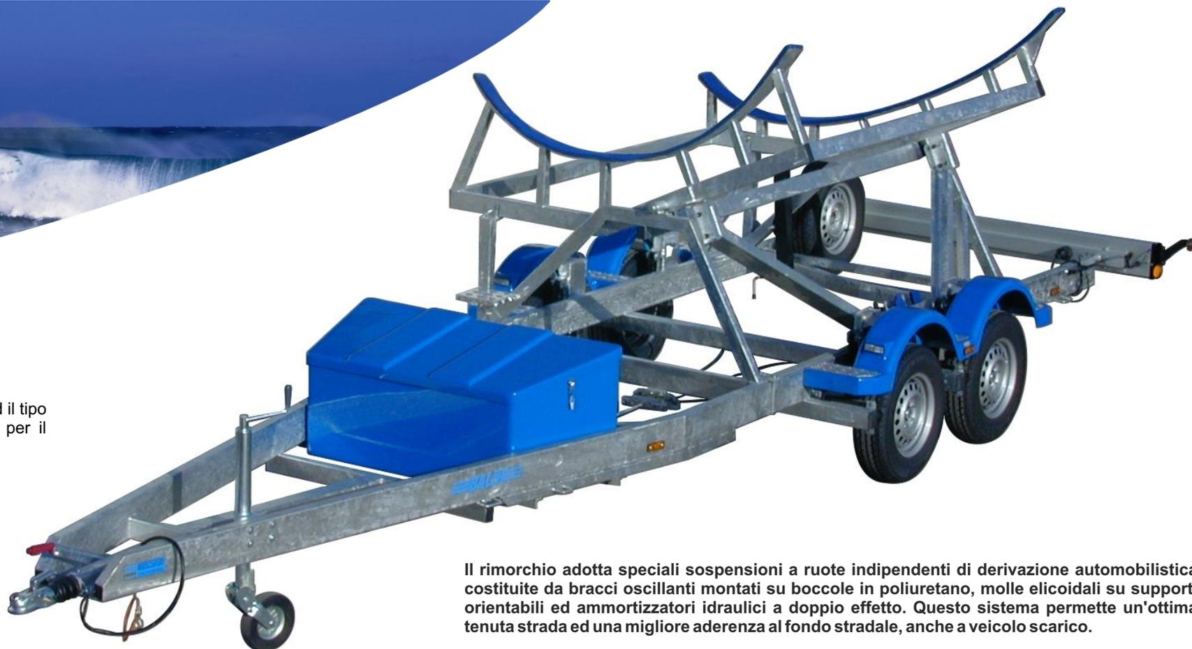
Il rimorchio adotta speciali sospensioni a ruote indipendenti di derivazione automobilistica costituite da bracci oscillanti montati su boccole in poliuretano, molle elicoidali su supporti orientabili ed ammortizzatori idraulici a doppio effetto. Questo sistema permette un'ottima tenuta strada ed una migliore aderenza al fondo stradale, anche a veicolo scarico.
