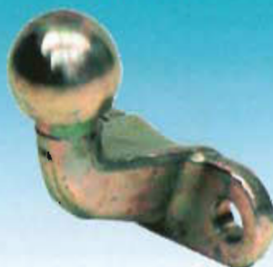
Crochet boule Ø 50 Fixations 2 trous Ø 17 x 90 P.T.C : 3,5 T
